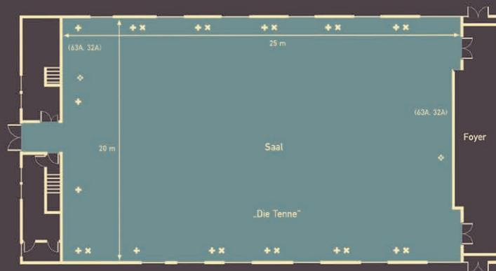
+ Steckdosen ▶ Telefon-, Fax und Modemanschluss ✦ Antennennanschluss ✦ LAN, ISDN-/PC-Anschluss ◊ Drehstrom
